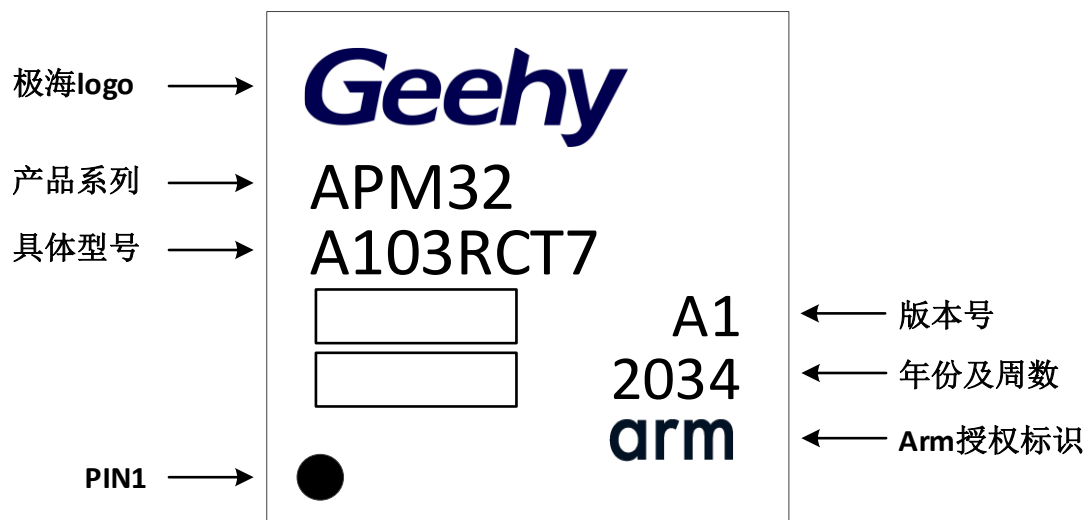
图 16 LQFP64-64 引脚，10×10mm 封装标识
